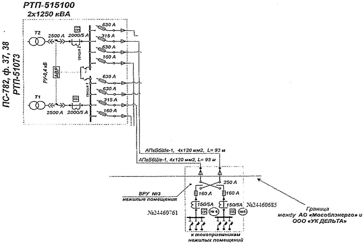
Примечание: в схеме указываются места установки и номера приборов учета, параметры измерительных трансформаторов тока и напряжения, границы балансовой принадлежности (красный цвет) и эксплуатационной ответственности (синий цвет), границы с субабонентами/транзитными потребителями (зеленый цвет), длина и марка питающих кабелей (проводов).
